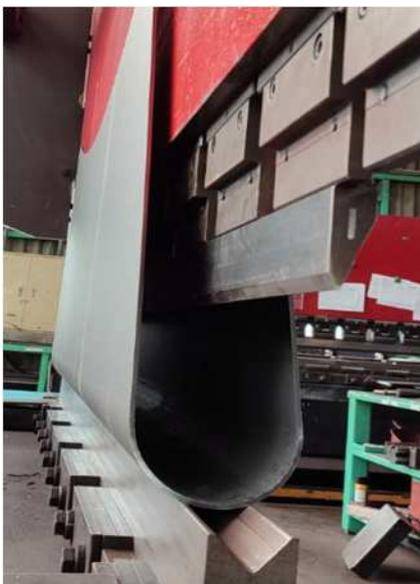
t4.5のU字曲げです。直部分とL寸法が長く加工しづらい曲げですが、ギリギリ機械に干渉せずに曲げることができました。
